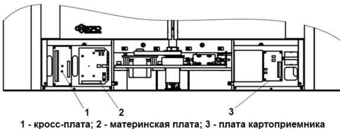
Рисунок 4 – Расположение плат на стойке модуля турникета
